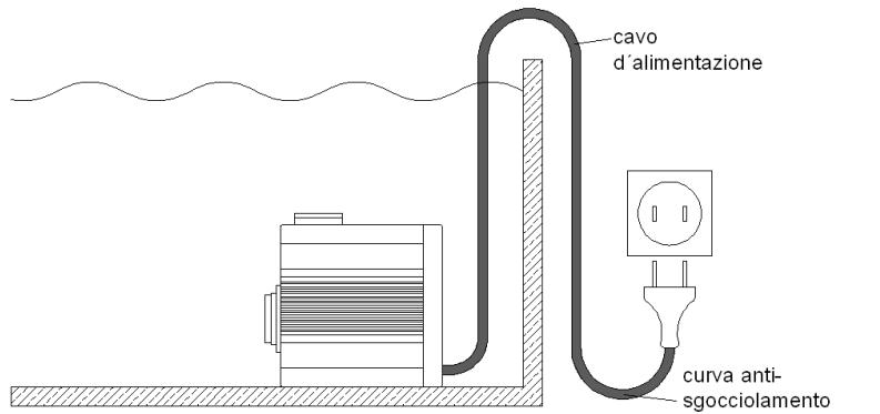
Eseguire l'operazione per tutti i componenti elettrici dell'acquario. In questo modo una parte di cavo si trova sotto il livello della presa, o della spina di collegamento nel caso si usi una prolunga, impedendo così che l'acqua gocciolando lungo il cavo venga a contatto con la presa.
